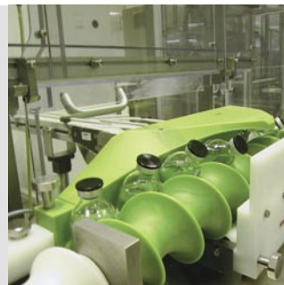
Transportni vijci od podmazanog lijevanog TECAST
